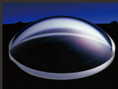
夏威夷莫纳基亚山山顶斯巴鲁望远镜中使用的主聚焦校正镜头系统
