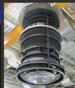
夏威夷莫纳基亚山山顶斯巴鲁望远镜中使用的主聚焦校正镜头系统
