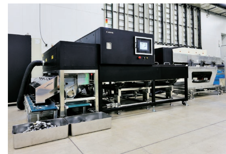
整合了测量与控制技术的塑料分选设备
