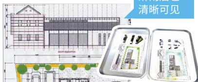
纸张打印后放置一天时间后喷水、晾干后进行对比
